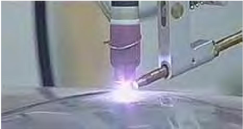
Assim como na soldagem TIG, na soldagem a plasma o arco é gerado entre um eletrodo não consumível (normalmente tungstênio) e a peça. A ponta do eletrodo, entretanto, fica posicionada no interior da tocha e o “gás-plasma” (não o gás de proteção) é forçado para fora do bico por um pequeno orifício. O arco fica assim constricto pelo fluxo de plasma propiciando uma alta energia com correntes relativamente baixas.
