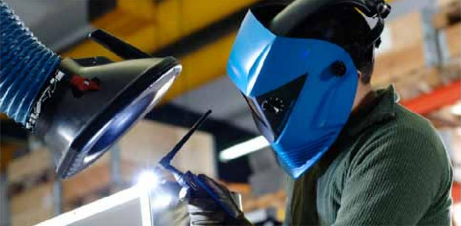
A coifa do braço extrator deve ser posicionada próxima e acima do ponto de solda em um ângulo de aproximadamente 45°. Para que se evite o risco de inalação dos fumos o soldador deve manter a cabeça fora da zona de extração. Os braços extratores são utilizados em sistemas de baixa pressão e tem a vazão situada entre 600 e 1.900 m<sup>3</sup>/h dependendo do modelo e da aplicação a que se destina.
