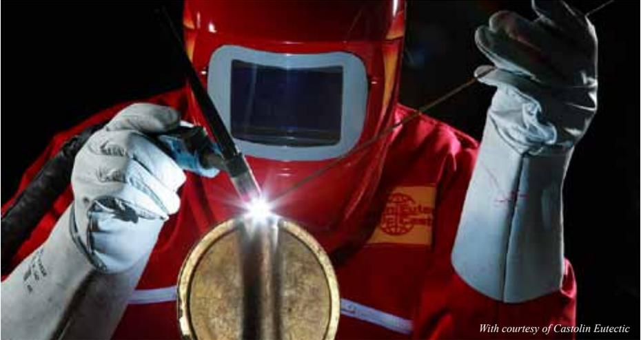
O processo de solda TIG (GTAW – Gas Tungsten Arc Welding), assim como o processo MIG, utiliza um gás inerte para a proteção da poça de fusão dos efeitos deletérios do ar. Diferentemente do MIG, porém, no processo TIG o eletrodo utilizado é de
