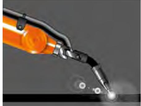
*A exaustão na tocha aspirada é especialmente adequada para solda robotizada. A técnica utiliza tecnologia de extração de alto vácuo Nederman com altas velocidades de captação e baixas vazões, para captar os fumos gerados na soldagem.*
