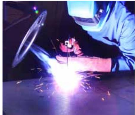
*A geração de fumos durante a soldagem. O intenso calor do arco elétrico vaporiza os componentes do eletrodo consumível e, em menor proporção, da poça de fusão. A coluna de ar aquecido que se eleva da área de solda carrega os vapores metálicos que se resfriam e se combinam com o ar formando óxidos metálicos na forma de um particulado (fumos) de baixíssimas dimensões.*
