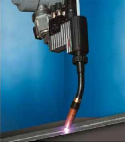
O processo CMT (Cold Metal Transfer) é relativamente recente. Ele permite que a soldagem seja realizada em temperaturas relativamente baixas da peça. O processo se baseia em uma transferência de metal através de curtos-circuitos controlados, que sistematicamente descontinua o arco.
