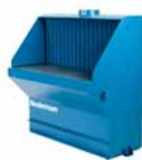
*Mesa industrial aspirada para exaustão de fumos e particulado proveniente de operações de soldagem, esmerilhamento e lixamento. Pode ser utilizada em aplicações com risco de explosão desde que convenientemente aterrada.*
