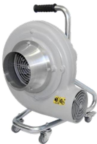
Fabricado com rotor e carcaça em alumínio fundido, é indicado para aplicações onde seja necessário o uso de comprimentos elevados de mangueira: até 20m, diam. 150mm. Adequado tanto para ventilação como exaustão localizada.
