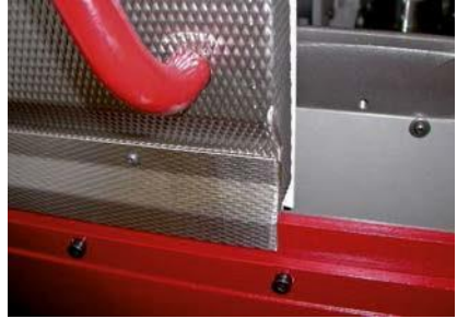
Figura 26 Detalhe de uma porta de correr com labirinto adicional para usinagem com óleo puro
