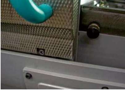
Figura 25 Detalhes de uma porta de correr projetada para maquinário com emulsão
