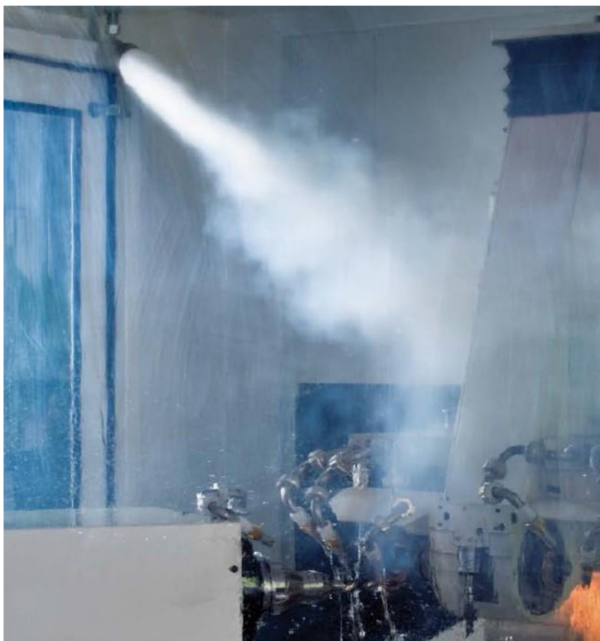
Figura 48 Extinção após detecção de incêndio
