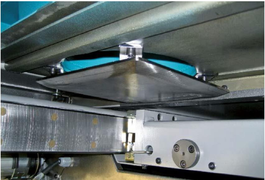
Figura 34 Placa do abafador acima do ponto de extração
