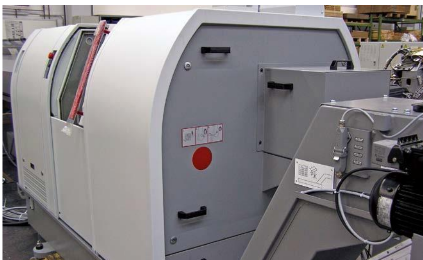
Figura 50 Orifício de extinção da máquina-ferramenta
