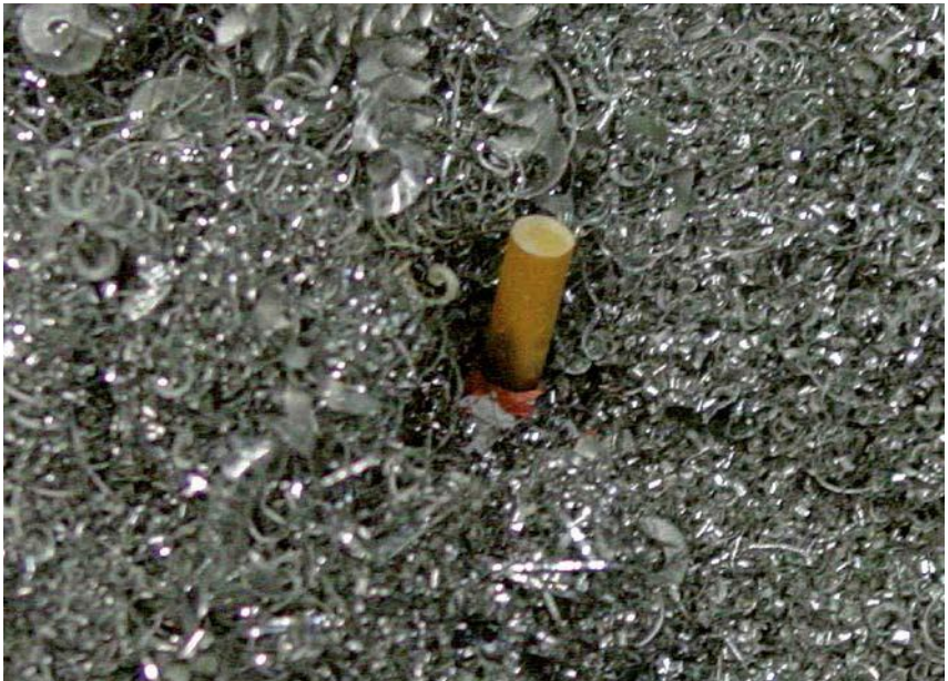
Figura 56 Fonte de ignição no recipiente de cavacos
