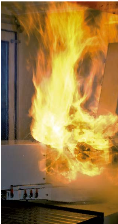
Figura 47 Ignição de fluido refrigerante durante o esmerilhamento com incêndio subsequente
