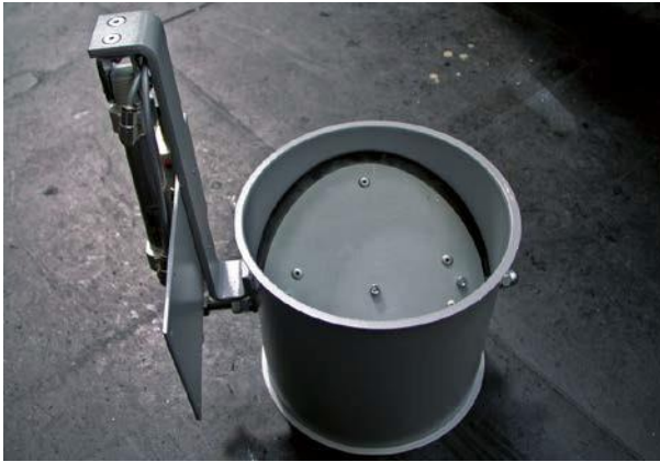
Figura 40. Válvula de desligamento para o ar extraído
