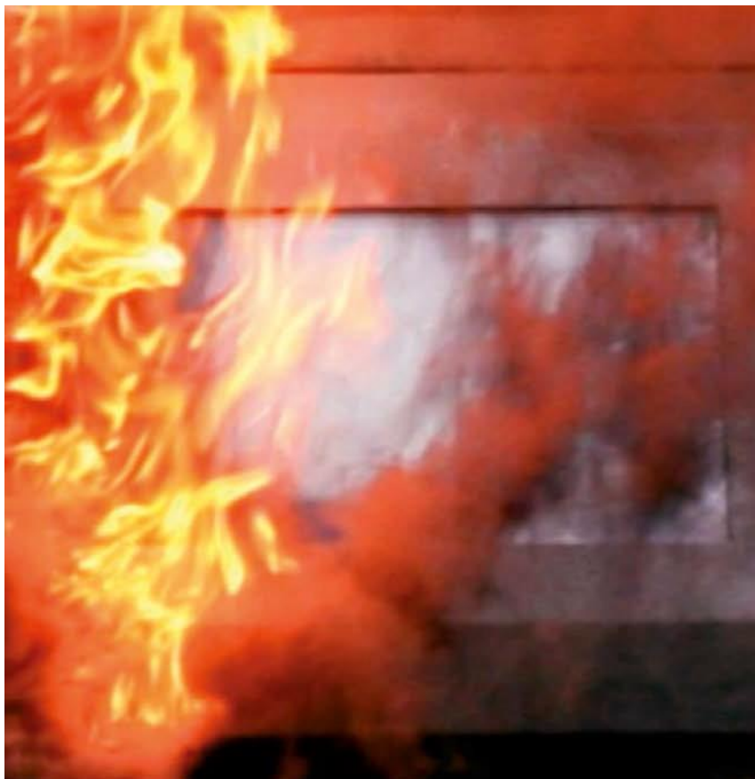
Figura 23 Ejeção de chamas de uma porta de labirinto
