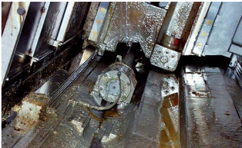
Figura 21 Formação de poça de óleo no compartimento de acionamento
