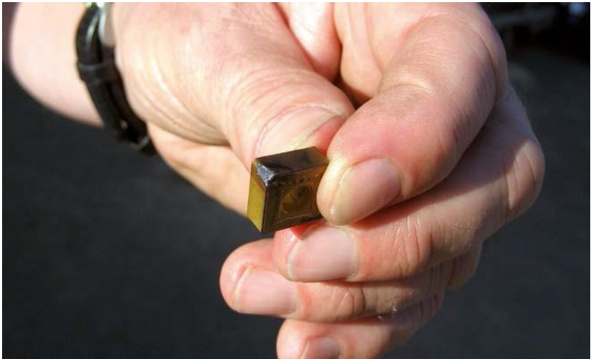
Figura 19 Inserto de corte indexável desgastado
