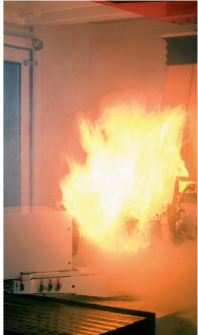
Figura 7 Reação em volta de um mandril
