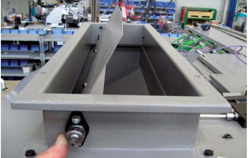
Figura 41 Válvula de alívio da pressão aberta
