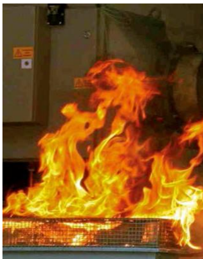
Figura 44 Flamejamento posterior subsequente à extinção
