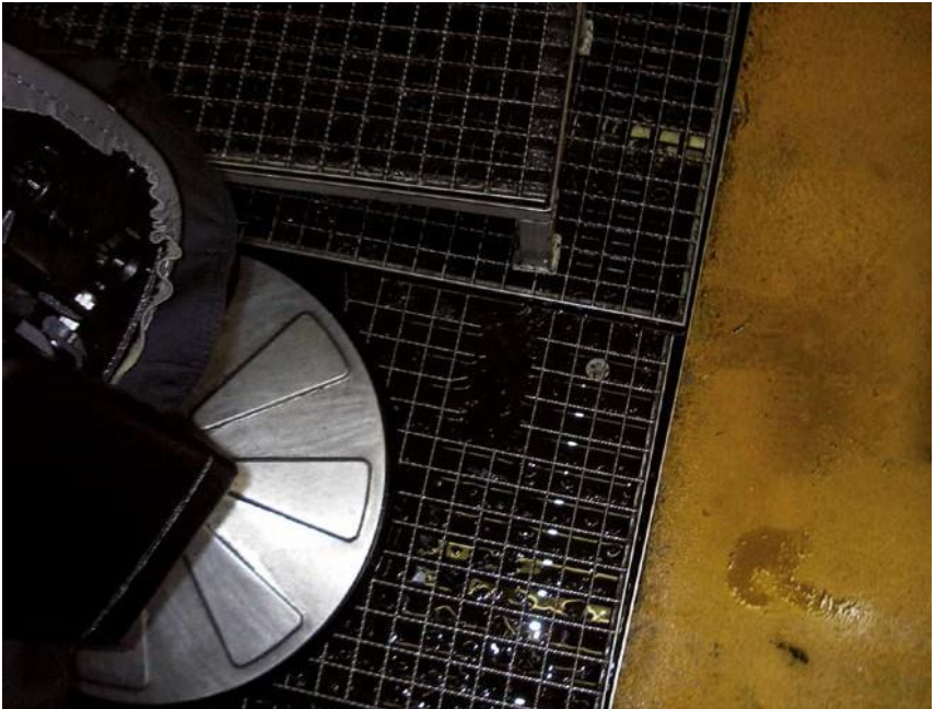
Figura 55 Grades cheias de óleo com áreas superficiais grandes
