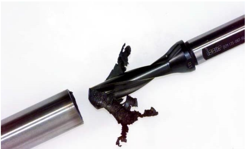
Figura 20 Broca operada a quente como fonte de ignição
