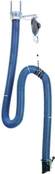
L'unité murale d'extraction des gaz d'échappement est une solution fiable et fonctionnelle pour tous types de véhicule à l'arrêt. Disponible avec équilibreur de tuyau ou simple bretelle de suspension. L'équilibreur soulève automatiquement au-dessus du sol, le tuyau et l'embout dès qu'il est déconnecté. Des modèles de tuyaux spécifiques pour des applications haute température sont disponibles.
