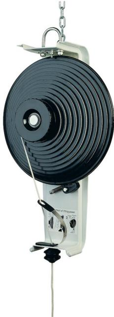
O equilibrador suporta a mangueira e o bocal e mantém o em posição de ser utilizado. O travão centrífugo integrado evita que a mangueira seja recolhida com demasiada velocidade o que previne acidentes pessoais ou materiais. Comprimento da corda, 8m.
