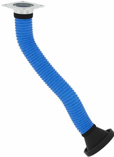
Телескопический вытяжной рукав Nederman предназначен специально для работы в ограниченном пространстве, насыщенном дымами, испарениями или взрывобезопасной пылью. Типичными рабочими помещениями для установки таких вытяжных рукавов могут быть мастерские учебных заведений или небольшие сварочные мастерские. Радиус действия вытяжного рукава составляет от 0,9 до 1,6 м.
