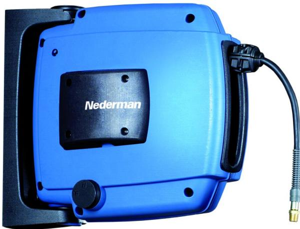
可伸缩的盘管盘管器H20可用来处理水和空气，适合轻工业,专业操作人员或diy工作间。H20盘管器是可伸缩的，由耐冲击的复合材料制成的稳健设计产品。该产品提供一个容易安装可脱卸的,可旋转的墙面支架和一种独特的，安全、易于服务的安全锁。该软管盘管器是同样适用于气动工具、钉枪和喷枪。这种盘管器是可伸缩的，而且配有一根优化的弹簧，确保了软管可以平滑的回收并缠绕到卷筒上面。优质的弹簧是在工厂预加力以适应范围广泛的应用,弹簧安装在盘鼓内部得到了很好的保护。H20自动回缩盘管器易安装,在墙上、天花板或地板上都可安装。
