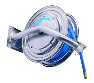
Cet enrouleur de tuyau en acier inoxydable est conçu spécifiquement pour l'industrie de traitement alimentaire. Grâce aux arêtes arrondies, il est facile à nettoyer et présente un tuyau de sortie facile à démonter, une articulation installée à l'extérieur et un nombre minimum de jonctions.
