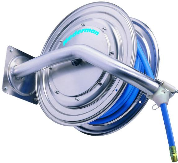
不锈钢盘管器，完全由不锈钢组成，特别为食品加工行业设计。倒圆的棱边和突出的易于拆除的软管出口，在外部安装的转环，以及最小数量的材料连接点，都使这款盘管器易于清洁。
