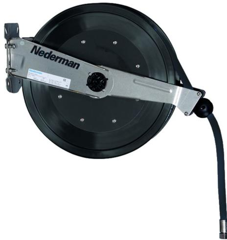
抗腐蚀盘管器由一个不锈钢旋转底座，黄铜的集线器，以及一个复合材料的盘鼓组成，这样的配置使盘管器更适合潮湿的工作环境。得益于开放式的设计，这种盘管器很容易检查，维修和清洁。这种盘管器可以安装在墙上或者天花板上。889系列盘管器的磁鼓较长，所以能够携带比888盘管器更长的软管。抗腐蚀盘管器适合安装在潮湿的工作环境例如洗车场，以及暴露的室外工作区域。所有的元件都是由高耐腐蚀的材料制作的。
