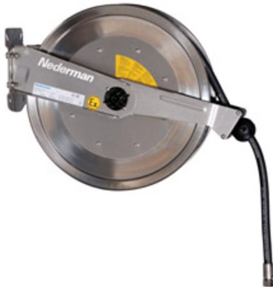
889型防爆盘管器是一款中型尺寸的工业用途盘管器。所有的主要元件都是由不锈钢或者导电符合材料制成，可用于化学腐蚀性或者易爆炸的环境。这种盘管器的设计使之安装以后更容易保持清洁和符合严格的卫生要求。根据ATEX 94/9/EC指令，886型不锈钢防爆盘管器也被批准用于1，2，21和22防爆区域。
