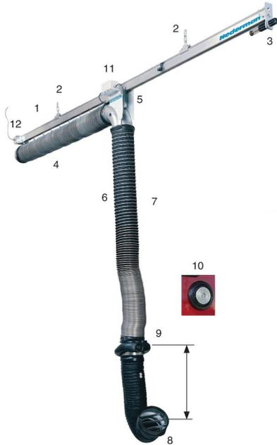
El MagnaTrack S es una alternativa económica a MagnaTrack HS diseñado para una frecuencia normal de salidas y velocidades de salida. MagnaTrack S tiene una cuerda elástica en el interior del tubo de salida (en lugar de un equilibrador) y un tope de goma (en lugar de una parada de carro hidráulico). El sistema de rail sirve un vehículo a la vez. MagnaTrack S está disponible en longitudes de 3,5 m hasta 18 m; (10 ft. a 60 ft.) y se ajusta a vehículos con tubos de escape montados bajos.
