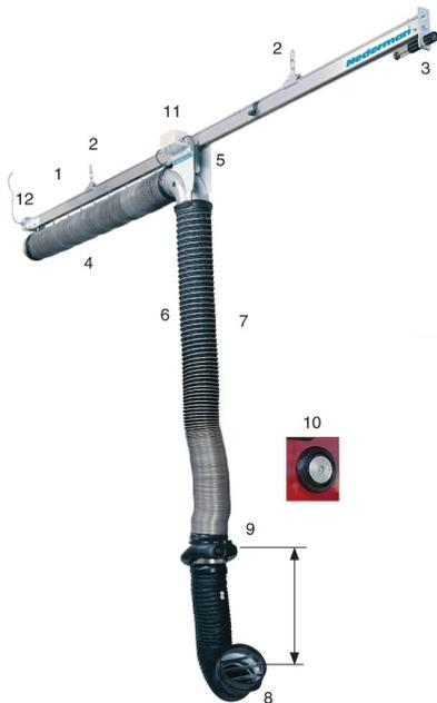
Le MagnaTrack S est une alternative économique au MagnaTrack HS conçue pour une utilisation normale et pour des vitesses de sortie standards. Magnatrack S dispose d'un cordon élastique à l'intérieur du tuyau d'échappement (au lieu d'un équilibreur) et d'une butée en caoutchouc (au lieu d'une butée de chariot hydraulique). Le système de glissière sert un véhicule à la fois. MagnaTrack S est disponible en longueurs de 3,5 m à 18 m; et s'adapte aux véhicules avec pot d'échappement en bas.
