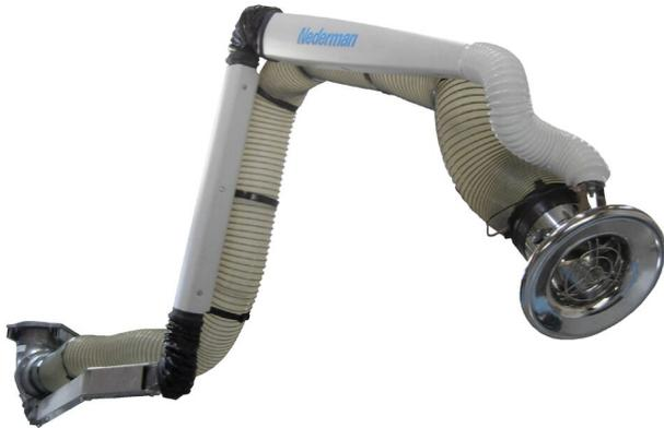
Der Nederman NEX DX ist doppelt geerdet und mit einem antistatisch geerdeten Abluftschlauch versehen, der den Aufbau statischer Elektrizität und Funkenentstehung verhindert. Der Arm ist für den Einsatz in Branchen geeignet, die höchste Hygiene Priorität genießt. Der NEX DX Arm hat verdeckte Verbindungen sowie einen einfach anzuschließenden Schlauch. Dank gekapseltem Stützarm, separatem Schlauch und Haube aus rostfreiem Stahl ist der NEX DX Arm wartungsarm und einfach zu reinigen.
