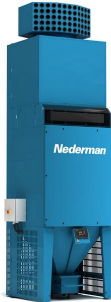
A torre de purificação de ar MCP-16 RC é um filtro de cartuchos compacto para limpeza e reciclagem do ar interior. A unidade filtrante compacta é fornecida com ventilador integrado, o ar poluído é extraído por baixo, encaminhado para a bateria filtrante de alta eficiência para ser devolvido à área de trabalho através dos bocais de distribuição instalados na parte superior da torre. A unidade é feita em chapa galvanizada e pintada de 2 mm de espessura.
