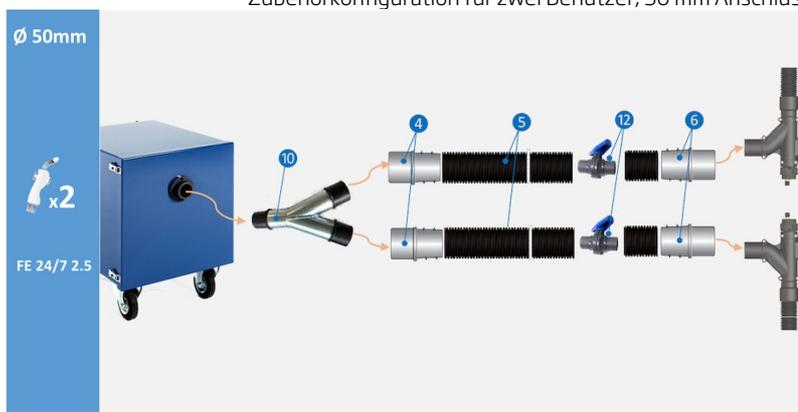
Zubehörkonfiguration für zwei Benutzer, 50mm Anschluss an Schweißmaschine. (10) Abzweig 50/50/50, Art.-Nr. 55999420 (4) Schlauchkupplung M50-50P, Art.-Nr. 55999416 (5) Schlauch PE-51 L=5 m, Art.-Nr. 55999412 (12) Kugelhahn 51 mm, Art.-Nr. 55999421 (6) Schlauchkupplung F50-50P, Art.-Nr. 55999417
