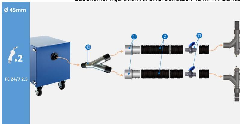
Zubehörkonfiguration für zwei Benutzer, 45 mm Anschluss an Schweißmaschine. (10) Abzweig 50/50/50, Art.-Nr. 55999420 (1) Schlauchkupplung M50-44P, Art.-Nr. 55999418 (2) Schlauch Superflex Ø 45 mm schwarz 5 m, Art.-Nr. 55999411 (11) Kugelhahn 44 mm, Art.-Nr. 55999422
