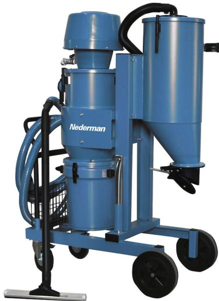
L'aspirateur industriel à sec 426A (pneumatique) est conçu pour l'élimination et la collecte de déchets industriels. Cette unité d'aspiration à sec puissante est livrée avec un silo et une préséparation cyclonique en amont du filtre HEPA, qui garantissent une filtration efficace de grandes quantités de matières.
