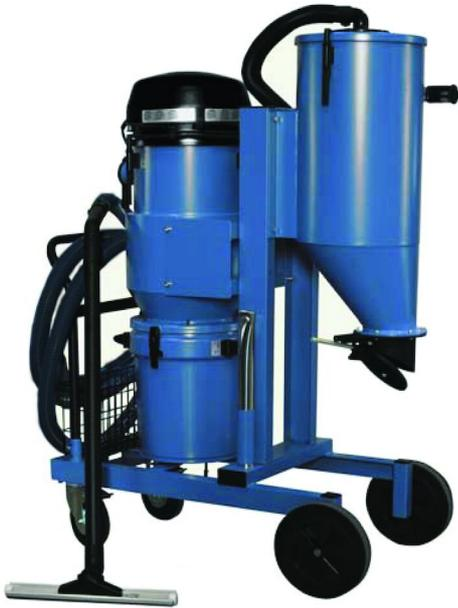
La aspiradora industrial 426E está diseñada para la extracción y recogida de residuos industriales y derrames. Esta unidad de succión de vacío seca de gran alcance viene equipada con un silo y un ciclón de separación previa antes del filtro, asegura la recogida eficaz de grandes cantidades de material. El vacío 426A Industrial también puede estar equipado también con un filtro HEPA para partículas más finas.
