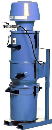
Einzelbehältersystem für die stationäre Installation Ausgestattet mit automatischem NCF-Filter, automatische Reinigung bei jedem Systemstopp. Zyklonabsaugung des Materials in einen 47-Liter-Behälter (12 gal). Leistungsstarke Vakuumeinheit für die Wiedergewinnung von Staub, Strahlgut und granuliertem Material. Eine effiziente Einheit für die Sammlung fettiger Späne, Dreh- und Bohrmaschinen in einem zentralen Absaugsystem.
