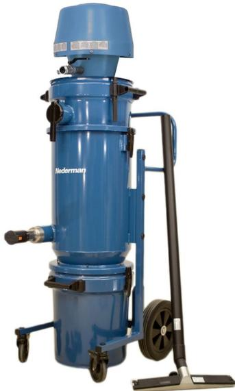
Промышленный пылесос 218A - идеальная машина для сбора очень тонкой невзрывоопасной пыли. Самоочищающийся фильтр и система очистки обеспечивают длительный интервал между заменой фильтров, что повышает производительность.
