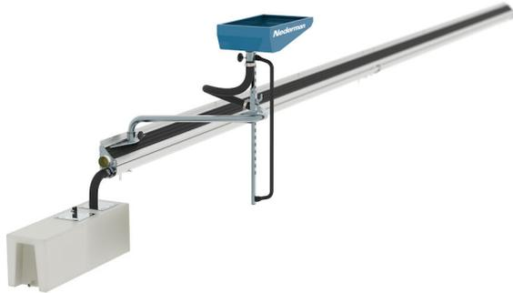
Le rail est installé en faible pente le long de la fosse, grâce à quoi les déchets d'huile s'écoulent directement vers l'extrémité du rail pour s'y déposer provisoirement dans un réservoir de 80 litres. L'huile usagée peut ensuite être drainée ou pompée dans un réservoir d'huiles usagées centralisé.
