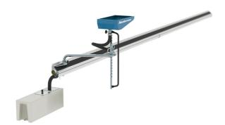
滑轨沿着工作坑安装,有小坡度,使废油自动流到滑轨尽头,暂时存储于一个80升的油箱。废油可排干,或注入中央废油箱。
