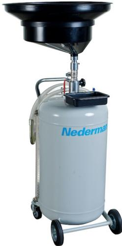
Los carros de tambor controlados manualmente y los pequeños tanques móviles son adecuados para el manejo efectivo de los aceites usados, fluidos y lubricantes de baja, media y alta viscosidad.
