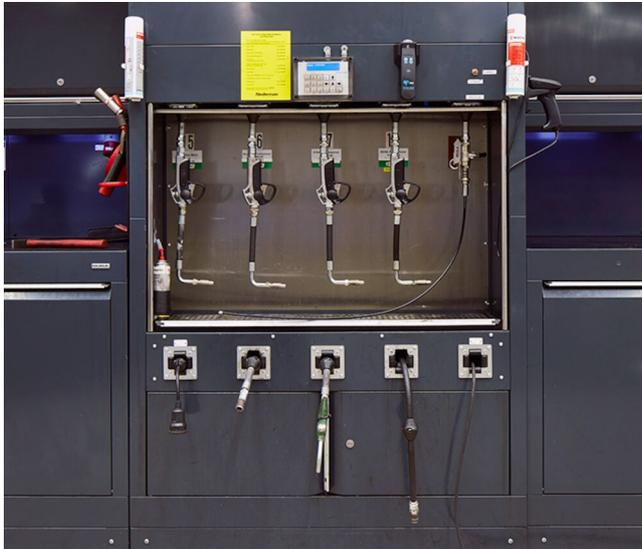
Nederman Monitoring System - NMS - est le système évolutif pour contrôler et surveiller l'huile, le liquide de pare-brise et d'autres fluides dans les stations-service de véhicules. Le système de surveillance de la lubrification NMS fournit un contrôle total des fluides, surveille avec précision et fournit la quantité correcte d'huiles et de fluides à tout véhicule sans opération manuelle.
