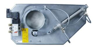
Les vannes TAV 100 et TAV 150 sont principalement utilisées comme vannes de coupure dans les plus grandes sections du système de tuyauterie. Comme les vannes peuvent se fermer et s'ouvrir automatiquement, la dépression se concentre toujours au niveau des connexions, des points d'extraction ou des machines en fonctionnement à cet instant. Ainsi, la puissance d'aspiration est accrue, les coûts de fonctionnement réduits et la taille de l'unité d'aspiration réduite au minimum.
