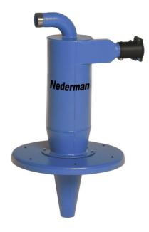
当需要将颗粒从气流中分离时通常会使用旋风分离器。旋风分离器一般位于筒仓、罐体、容器等适合储存所收集物料的地方,因此旋风分离器起到一个沉降箱的作用。通常在旋风分离器和真空动力装置之间应安装一个过滤器。
