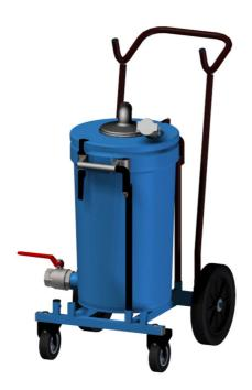
移动式预分离器的用于收集和再循环油、切削液、冷却液、水和其他不易燃液体。完美的金属加工行业,钻孔,铣削和车削。当容器充满时,浮球会自动关闭抽吸水流。移动预分离器安装有用于收集液体容易放电可倾翻的容器。进风口和出风口直径为51毫米(2英寸)用于夹头(43930101和43930102)。在大多数的真空收集和运输系统中,预分离收集到的材料,在材料到达过滤器是非常重要的。为了避免堵塞采用预分离的萃取装置是前提。预分离器连接在一个高真空单元之前。
