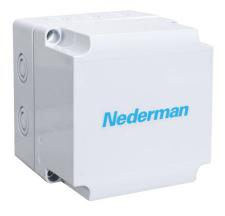
Pour une fonction marche-arrêt automatique en combinaison avec une série de clapets motorisés. (Des ventilateurs industriels de plus grande capacité peuvent être commandés à distance via le démarreur ou le variateur de fréquence pour ventilateur industriel Nederman.) Le contacteur de ventilateur industriel comporte une protection thermique moteur. Classe de protection IP66. Bobine 24 V AC, à partir du boîtier de commande ou du transformateur.
