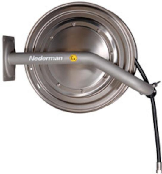
在一些特殊的环境中例如离岸产品在含盐量过高的空气中，或者在含氟量过高的游泳池或者浴室，或者在其他使质量变坏的物质应用中，都有腐蚀一般不锈钢的危险。在这类应用中，尼的曼提供上面提到的886盘管器防爆系列。所有暴露在外面的元件由耐酸的不锈钢和抗化学腐蚀的复合材料组成。经ATEX 2014/34/EC 批准可用于安装在防爆1, 2, 21, 以及22区。
