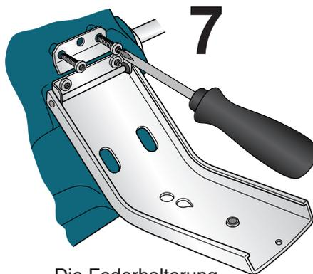
Die Federhalterung an der anderen Seite des Absaug Schlittens befestigen.
