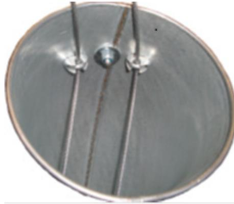
Die Ablösung des Halte-Magneten erfolgt durch zwei Drähte im Inneren des vertikalen Schlauches. Der eine Draht wird an der Rückseite des Dauermagneten befestigt und der andere Draht wird mit einer Feder an der Montagegruppe des Dauermagneten befestigt. Die entgegengesetzten Enden der beiden Drähte sind im Inneren des Bogenstücks, welches am Balancer aufgehängt ist, befestigt.
