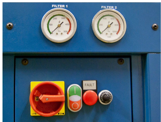
De FilterBench is uitgerust met drukverschilmeters die duidelijk aangeven wanneer het tijd is om de filters te vervangen.
