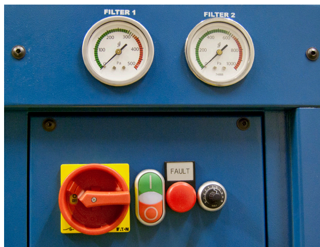
Zařízení FilterBench je vybaveno tlakoměry jasně udávajícími, kdy je čas filtry vyměnit.
