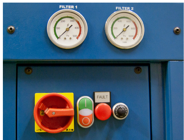
Die Druckmessgeräte der FilterBench geben deutlich zu erkennen, wenn Filter zu wechseln sind.
