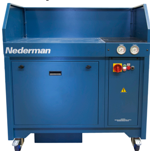
Die Druckmessgeräte der FilterBench geben deutlich zu erkennen, wenn Filter zu wechseln sind.
